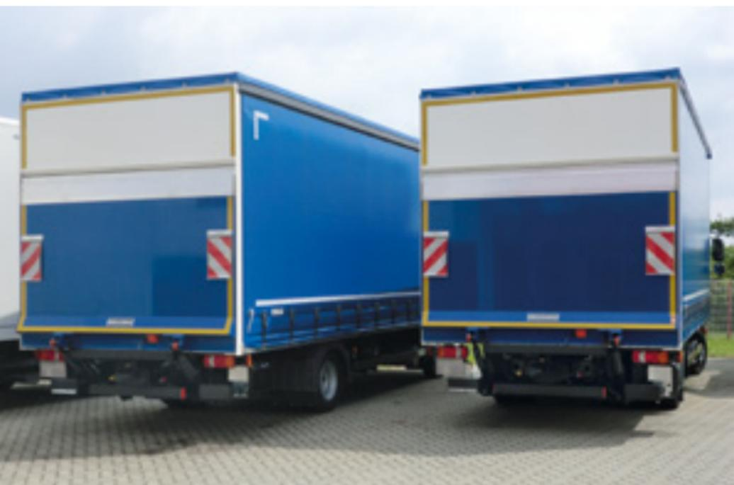
La DH-LMQ.07 (500-750 kg) e la DH-LMQ.10 (500-1000 kg) sono dotate di piastre premontate ad un interasse prestabilito. Queste robuste versioni a 4 cilindri senza traversa consentono di **ridurre il peso**, e di lasciare la **ruota di scorta nella posizione originale** (nella maggior parte dei casi), senza compromettere la stabilità.
